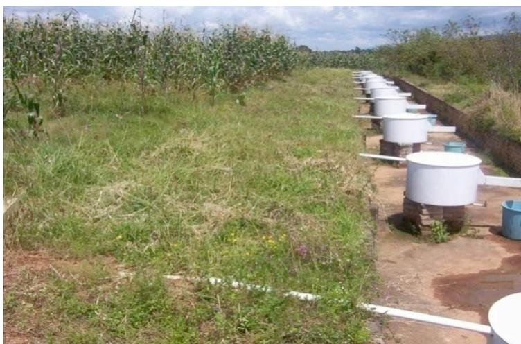
**Figura 5. Sistema de aforo de escurrimientos superficiales en el sitio 1.**
