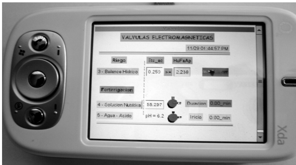
Figura 38. Monitoreo del estado de las válvulas de control del riego y la fertirrigación a través de una Pocket PC
