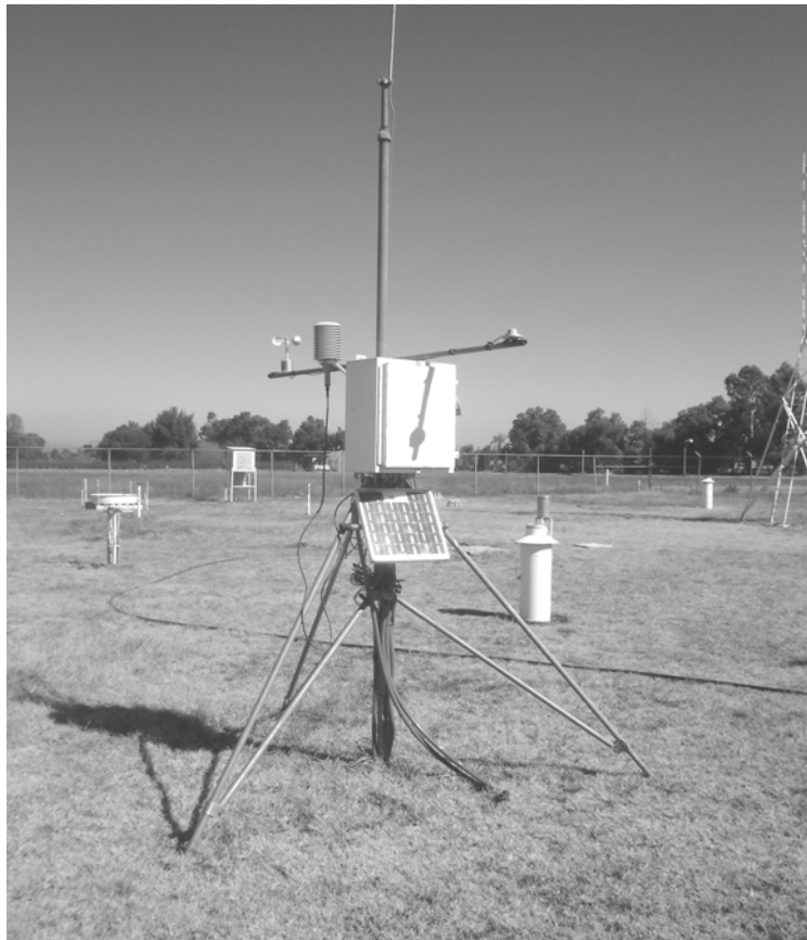
Figura 6. Unidad de control y estación meteorológica automática
